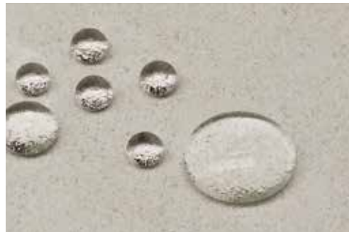
hydrophobieren: Den Baustoff wasserabweisend machen.
