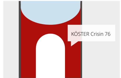
verengen / verstopfen: Die Pore mit einem elastischen Film auskleiden.
