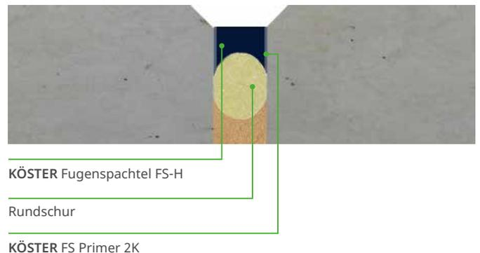
Aufbau einer Bewegungsfuge, abgedichtet mit Fugenspachtel
