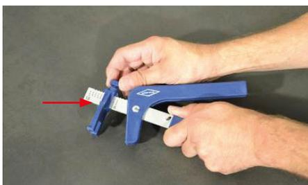
**7** An der zum System gehörenden Spannzange ist die jeweilige Materialstärke einzustellen. Der verstellbare vordere Anschlag ist dabei an der Zahlenskala auszurichten. Feststellschraube gut anziehen.
